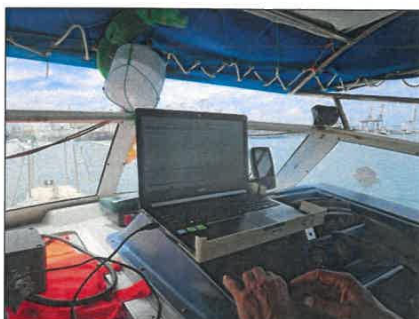
รูปที่ 41 ต่อพ่วงอุปกรณ์ GPS และ ECHO SOUNDER เข้ากับ COMPUTER
