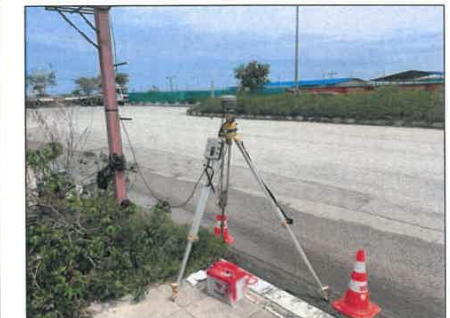
รูปที่ 10 เครื่องมือวัดด้วยดาวเทียม GNSS
