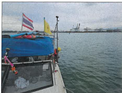
รูปที่ 40 ติดตั้งเสาอากาศเครื่อง GNSS และ Transducer
